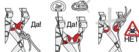
Рис. 7. Завязывание узла "восьмерка" для применения в спорте
