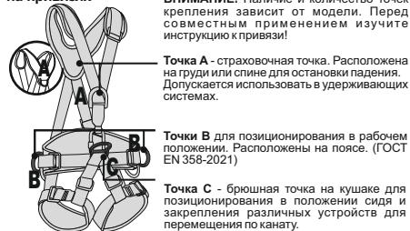
Рис. 4. Расположение и назначение крепежных точек на привязях
