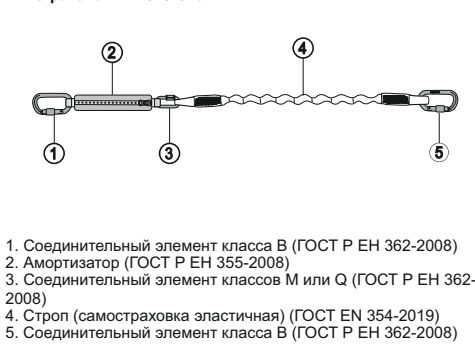
Рис. 7. Состав соединительно-амортизирующей подсистемы в страховочных системах
