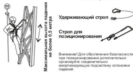
Рис. 12. Позиционирование в рабочем положении
