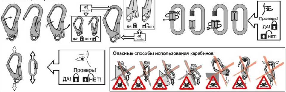
Рис. 7. Способы крепления стропов к анкерным устройствам
