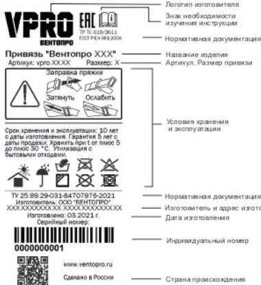
Рис. 3. Маркировка изделия (типовой образец)
