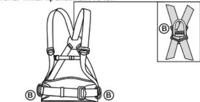
Рис. 2. Типы крепежных точек
