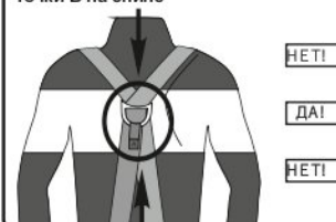
Рис. 6. Правильное положение страховочной точки В на спине
